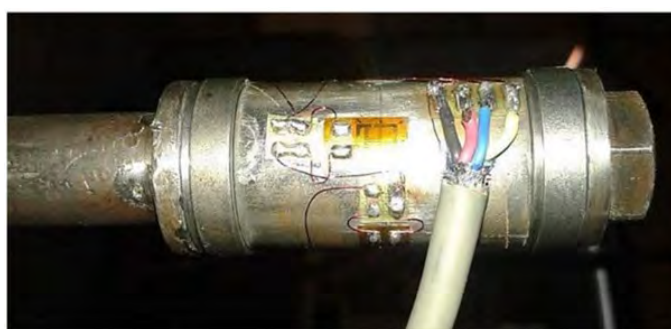
Figura 4.12. Prototipo de tope de impacto instrumentado con extensómetros Espinosa (2015).
