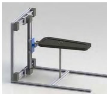
Figura 2. 11: Rehabilitador de tobillo de 2 GDL con movimientos X-Y [41], [42].
