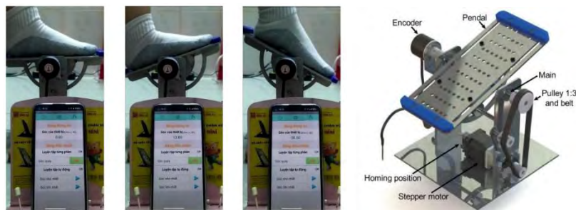
Figura 2. 21: Rehabilitador AnkleReHabit de 1 GDL [56].
