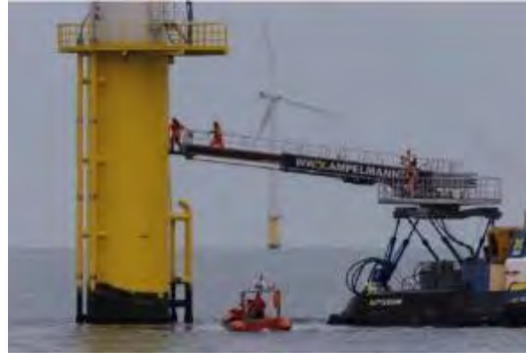
Figura 3.1 Plataforma de sistema de acceso a altamar Ampelmann [36].
