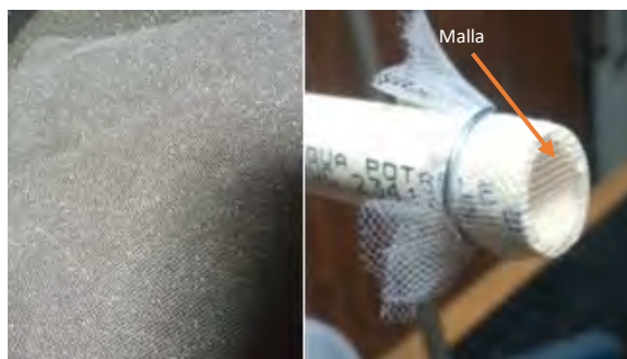
Figura 5.3. Colocación de la malla en el tubo para la salida uniforme del fluido
