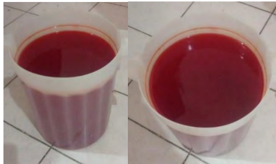
Figura 5.11. Fluido similar a la sangre para que pase por el interior del banco de pruebas
