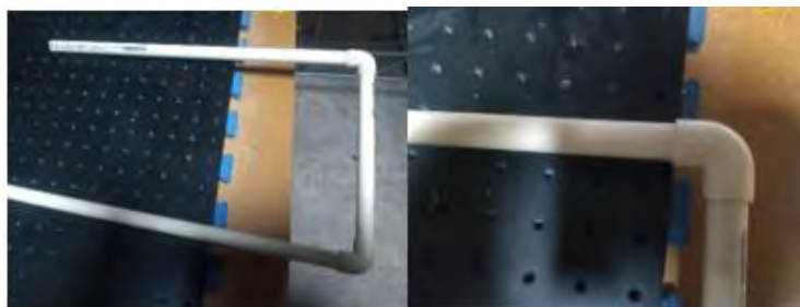
Figura 5.2. Pegado de los tubos con coples y codos para hacer el circuito del fluido.
