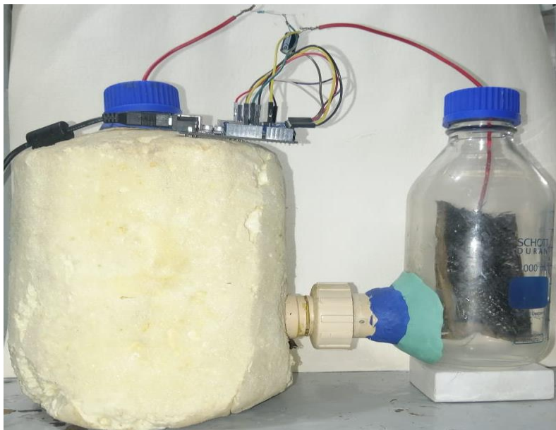
Figura 3.2 Celda de combustible microbiana con recubrimiento de espuma de poliuretano en la cámara anódica.
