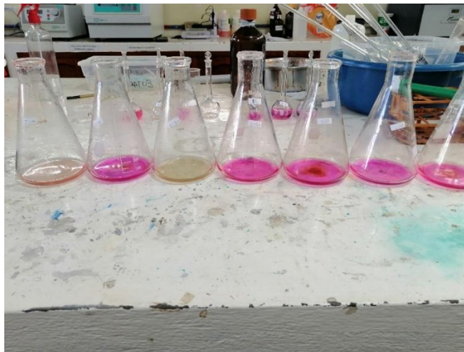
Ilustración 17: Ejecución de la metodología de determinación de Fosforo en muestra de residuo Bovino
