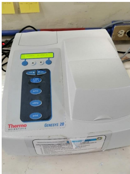
Ilustración 14: Espectrofotómetro (Thermo Genesys 20), utilizado para la medición de absorción de las muestras de interés.
