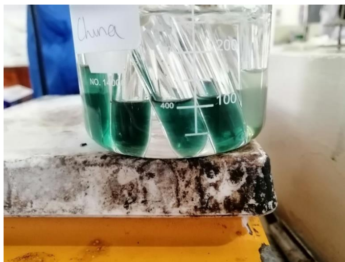
Ilustración 7: Digestión de muestras utilizando el método de Baño María para la determinación de carbohidratos
