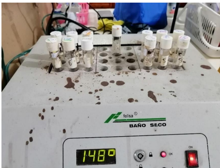
Ilustración 16: Placa de calentamiento (Felisa), utilizada para el desarrollo de la técnica de determinación de D.Q.O., para la digestión de las muestras de interés
