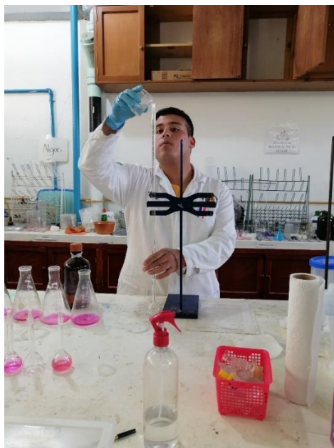
Ilustración 18: Preparación de reactivo combinado para la determinación de Fosforo, previo a la medición de absorbancia mediante el uso del Espectrofotómetro.
