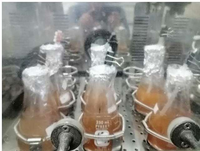
Ilustración 6: Desarrollo de la cinética anaerobia del lactobacilo L. Cassei en sus diversas concentraciones (5%, 10% y 15%) utilizando un agitador orbital
