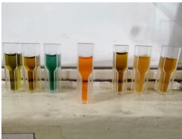
Ilustración 15 Muestras posterior a digestión habiendo usado la placa de calentamiento (Muestras de D.Q.O. lado izquierdo, Blanco ubicado en el centro, Muestras de D.Q.O. Soluble lado derecho).
