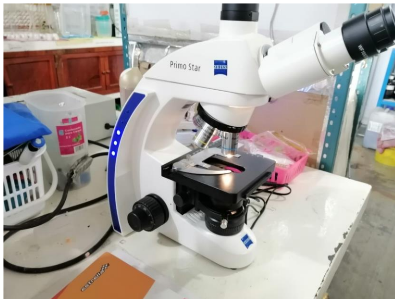
Ilustración 21: Microscopio Zeiss Primo Star, UNAM 02504632, empleado para el conteo celular de los agentes biológico.
