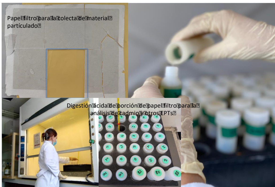
Figura 3. Proceso de digestión ácida de muestras de filtros.
