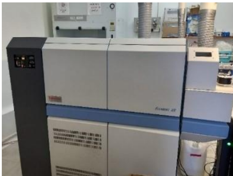
Figura 4. HR-ICP-MS de sector magnético Finnigan MAT Element XR®
