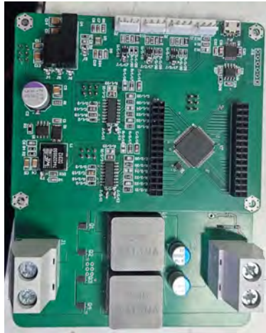
Figura 4.13: Acoplamiento de tarjetas de control y potencia para el sistema de electrolisis.
