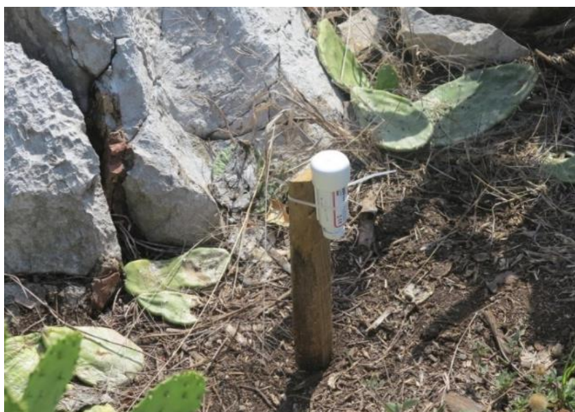
Figura 6. Registrador HOBO Pro v2 (OnSet) sujeto a una estaca y colocado a 10 cm sobre el suelo en el sitio con cultivo de nopal.
