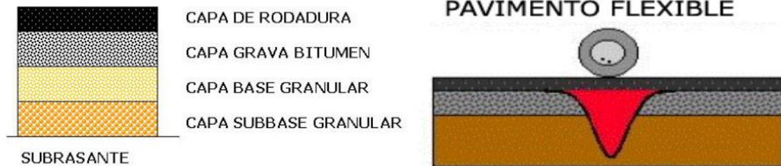
Imagen 1 Estructura del pavimento flexible
