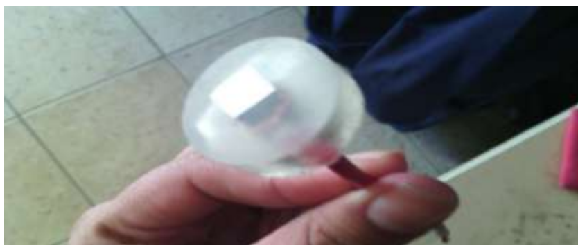
Figura 6. Probeta encapsulada con resina epóxica.
