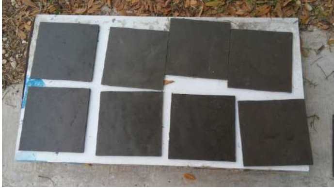
Figura 7. Curado de muestras del panel de cemento.
