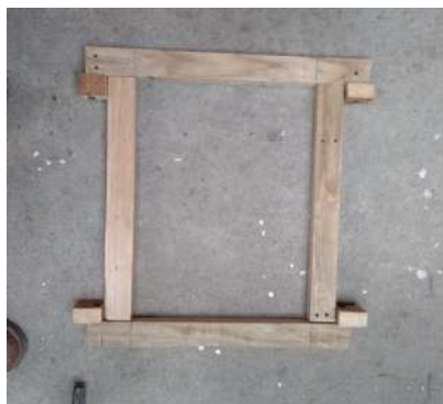
Fotografía 5. Molde I 30 x 40 cm. elaborado de madera de pino, 2019. Elaboración propia
