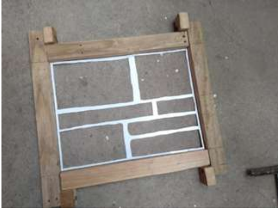
Fotografía 9. Plantilla de poliestireno para estampado, 2019. Elaboración propia.
