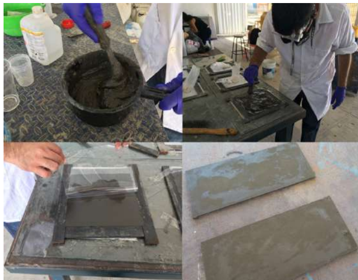
Figura 5. Fabricación de muestras del panel de cemento.
