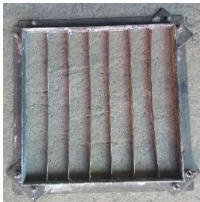
Fotografía 6. Molde II 30 x 30 cm. elaborado de ángulo metálico, 2019. Elaboración propia.
