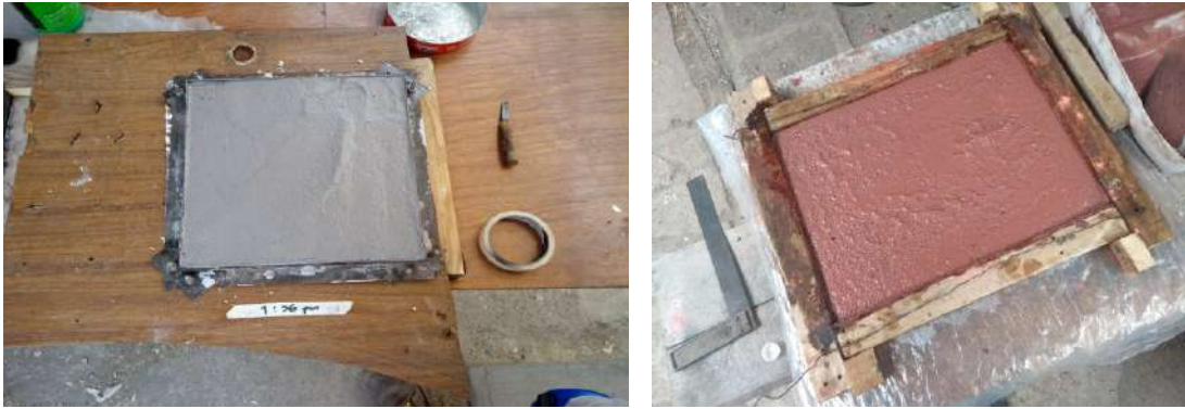
Fotografía 11. Vaciado de mezcla en molde I y molde II, 2019. Elaboración propia.
