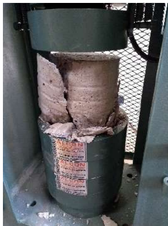
Fotografía 13. Prueba de concreto a la Compresión, Tecnológico de Estudios Superiores de Ixtapaluca, 2019. Elaboración propia.
