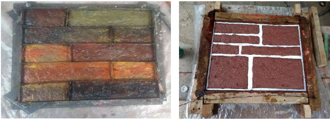
Fotografía 12. Estampado en molde II y pigmentado en molde I, 2019. Elaboración propia.
