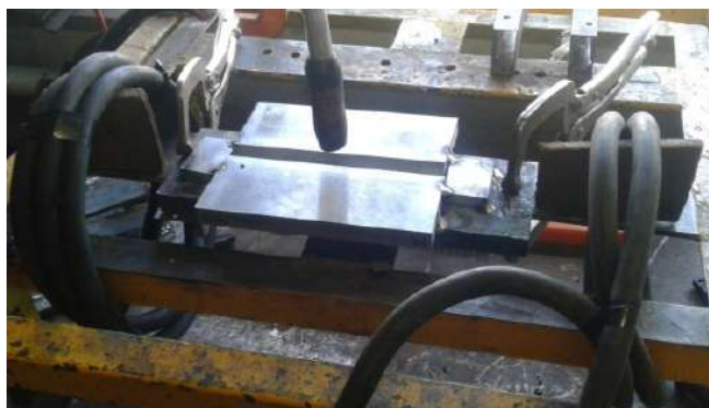
Figura 3. Arreglo experimental para soldar las placas bimetálicas con aplicación de campo magnético externo.
