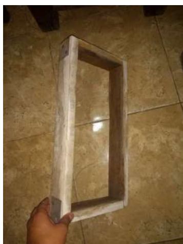
Fotografía 7. Molde III 20 x 45 cm elaborado de madera de pino, 2019. Elaboración propia.
