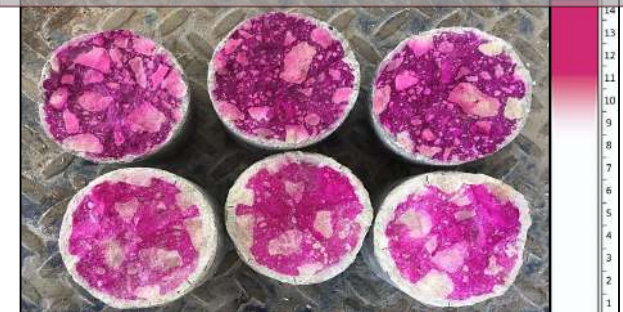
Especímenes de concreto, experimental (arriba) y testigo (abajo). La escala derecha muestra la coloración según el rango de pH.
