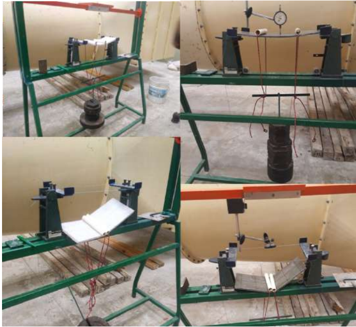
Figura 14. Flexión de los paneles.
