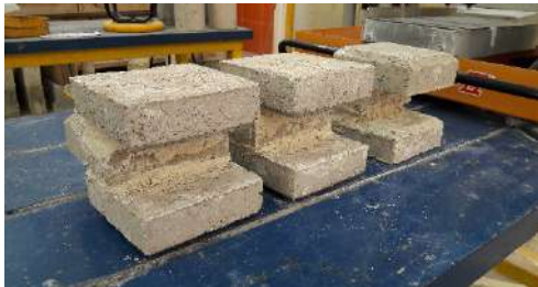
Figura 3. Adoquines unidos con mortero testigo y sustituidos.
