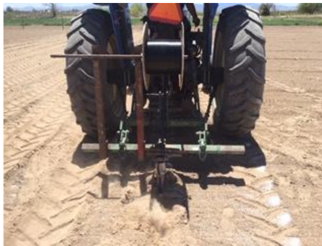
Figura 3.4. Instalación de cintilla a 15 cm de profundidad
