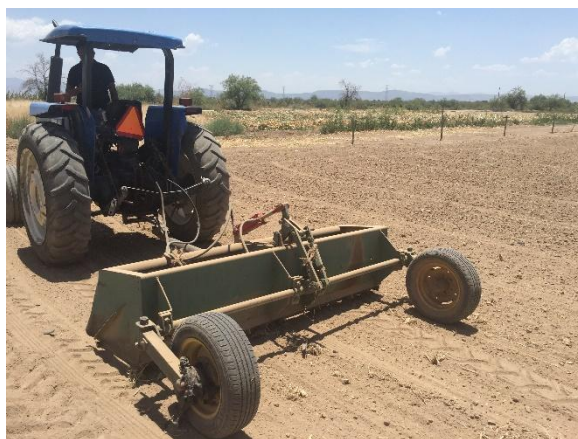
Figura 3.3. Nivelación con escrepa
