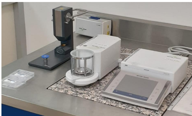
Figura 1.12 Microbalanza y prensa para medir y sellar muestra de material analizado.
