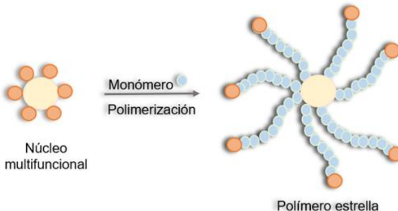
Figura 3. Síntesis de estrellas poliméricas utilizando el enfoque de primero el núcleo. 18
