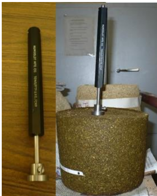
Figura 6. Medición de la dureza de los MBN con penetrómetro.
