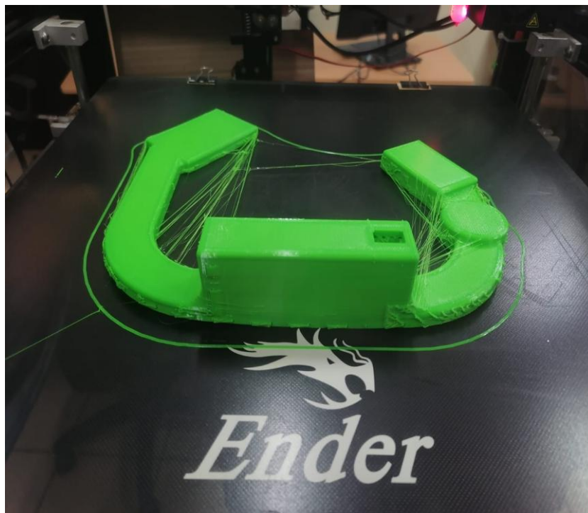
Figura 3.117. Pieza trasera impresión en 3D con filamento TPU.
