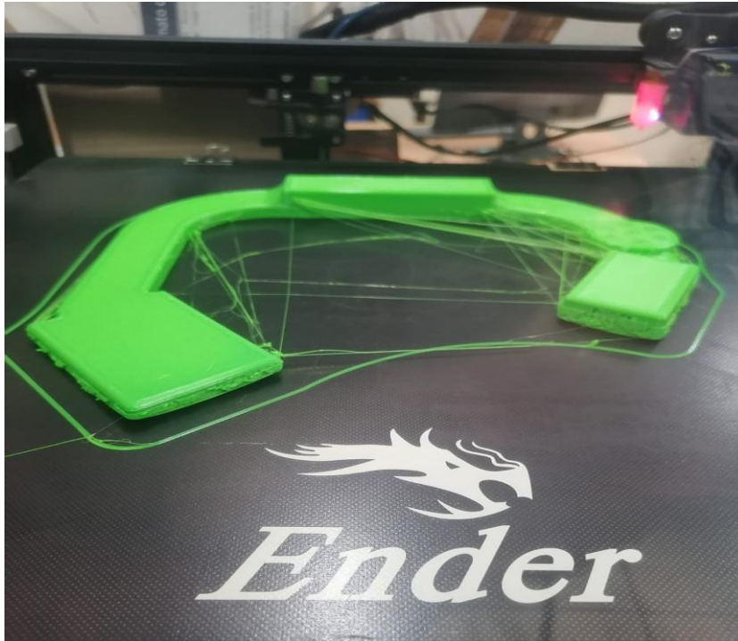
Figura 3.118. Pieza delantera impresión en 3D Con filamento TUP.
