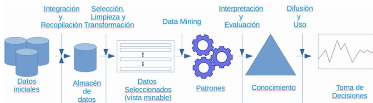
Imagen 2.2 Proceso KDD. Fases de gestión, análisis y explotación de datos (Fayyad, 1996).
