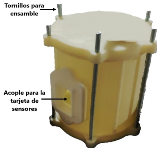
Figura 3.26: Celda de medición para gases.
