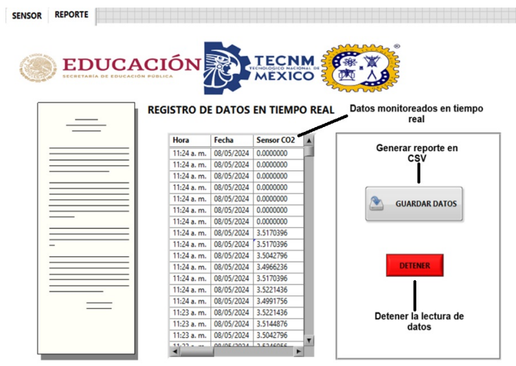
Figura 3.17: Interfaz gráfica para monitoreo en tiempo real del sensor de CO_2 .
