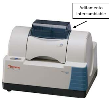
Figura 3.4: Espectrofotómetro Thermo Scientific iS5 [30].
