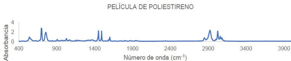
Figura 3.6: Gráfica del espectro de absorción de IR para una película de poliestireno, usado para calibrar el equipo.
