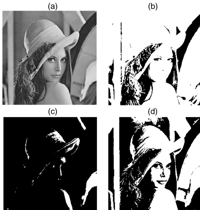
Figura 15.- Fotografía de Lenna; (a) con 256 niveles de gris, (b) con un umbral bajo, (c) con un umbral alto, (d) con un umbral intermedio.
