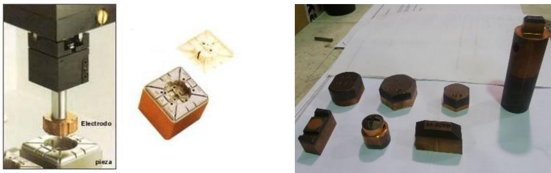
Figura 2.9. Ejemplos de las formas que pueden tener los electrodos de cobre.
