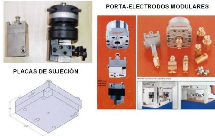
Figura 2.10. Placas de sujeción y porta-electrodos modulares. Se pueden ver combinaciones, desde montajes directos a montajes con elementos que facilitan la orientación del electrodo
