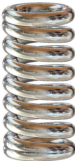
Figura 3.9. Vista isométrica del resorte. El resorte cuenta con un largo de 15.5 mm, un diámetro exterior de 7.5 mm y un diámetro interno de 4.5 mm, el espesor del resorte es de 1.5 mm.
