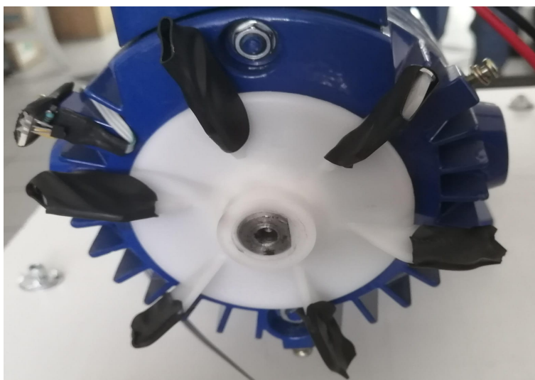
Figura 1.7. Detalle de la incorporación de los imanes de neodimio al ventilador.
