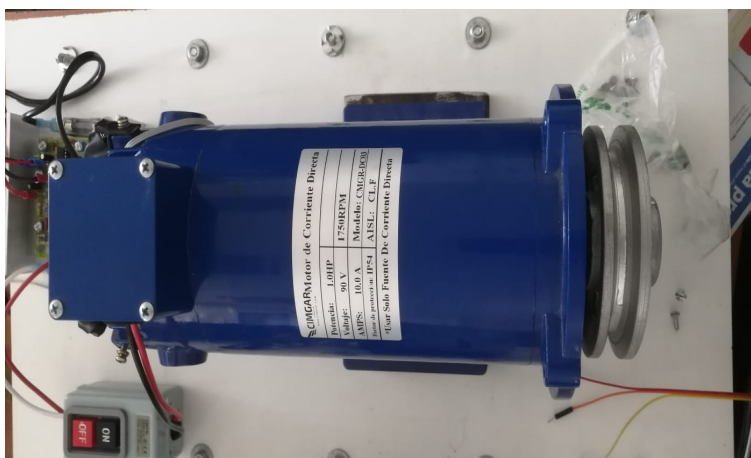
Figura 1.13. Motor CIMGAR de imanes permanentes
