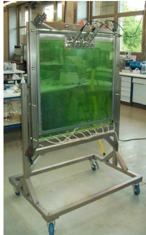
Ilustración 2 Fotobiorreactor de placas planas
