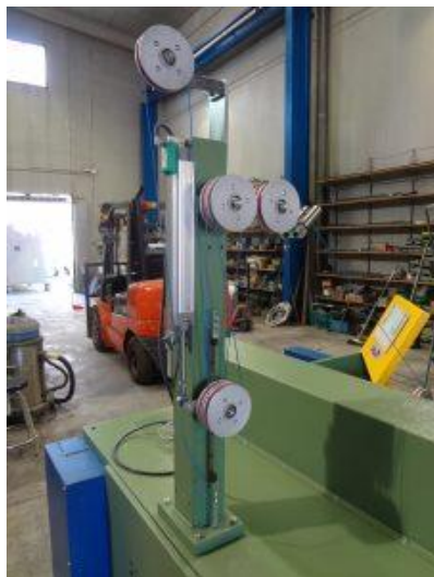
Imagen 14- Acumulador de poleas para insertar los hilos – muestra
