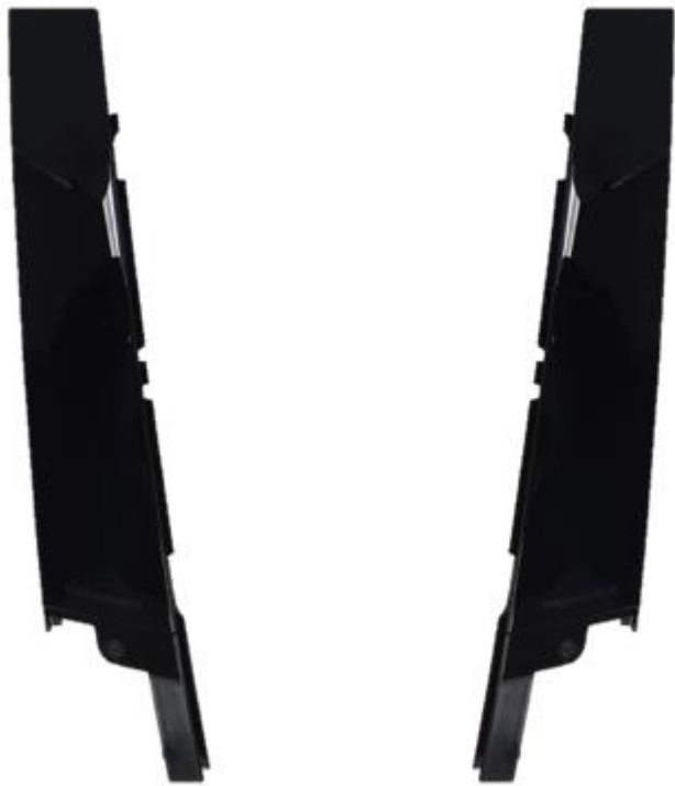
FIGURA 11PIEZA MÁSTER PILLAR B TRASERO (CAMARILLO,2024)
