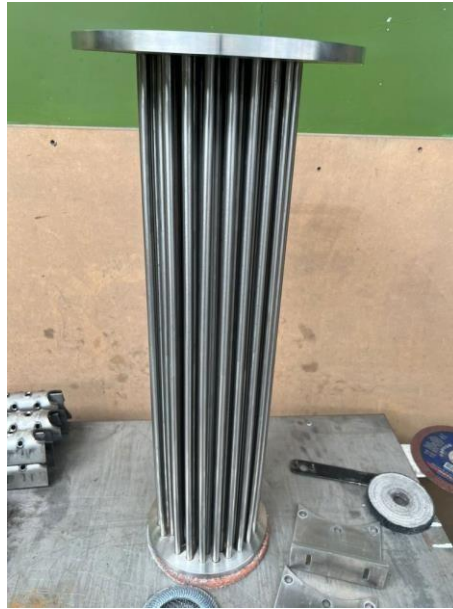
Figura 38 Montaje completo de bridas soldadas al serpentín.
