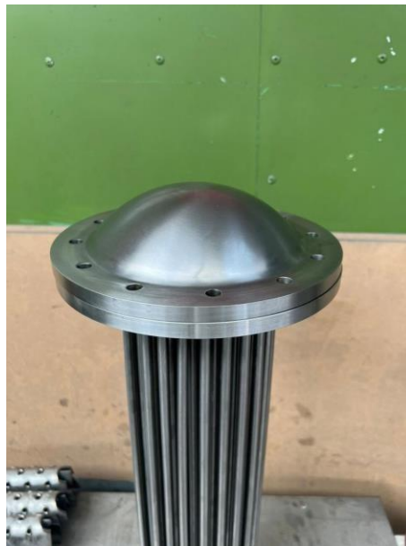
Figura 41 Vista previa de la tapa abombada con la brida del serpentín.
