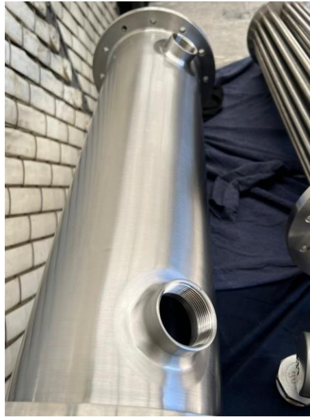
Figura 35 Cuerpo o carcaza terminada y pulida en su totalidad.
