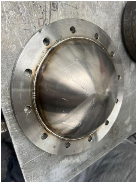
Figura 39 Tapa abombada sin entrada y salida de agua caliente o vapor.
