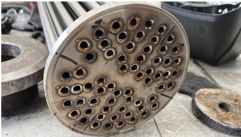
Figura 37 Proceso de soldado del serpentín con brida inferior.
