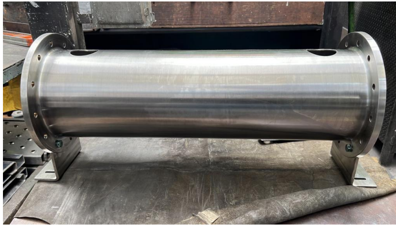
Figura 33 Cuerpo o carcaza montada en base.
