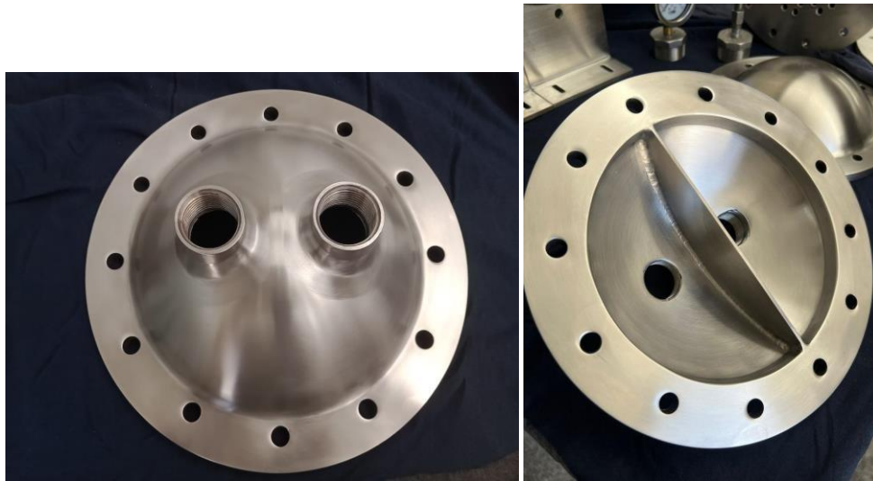
Figura 40 Tapa abombada con entrada y salida de agua caliente o vapor.
