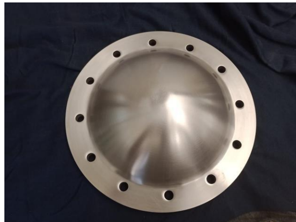
Figura 39 Tapa abombada sin entrada y salida de agua caliente o vapor.
