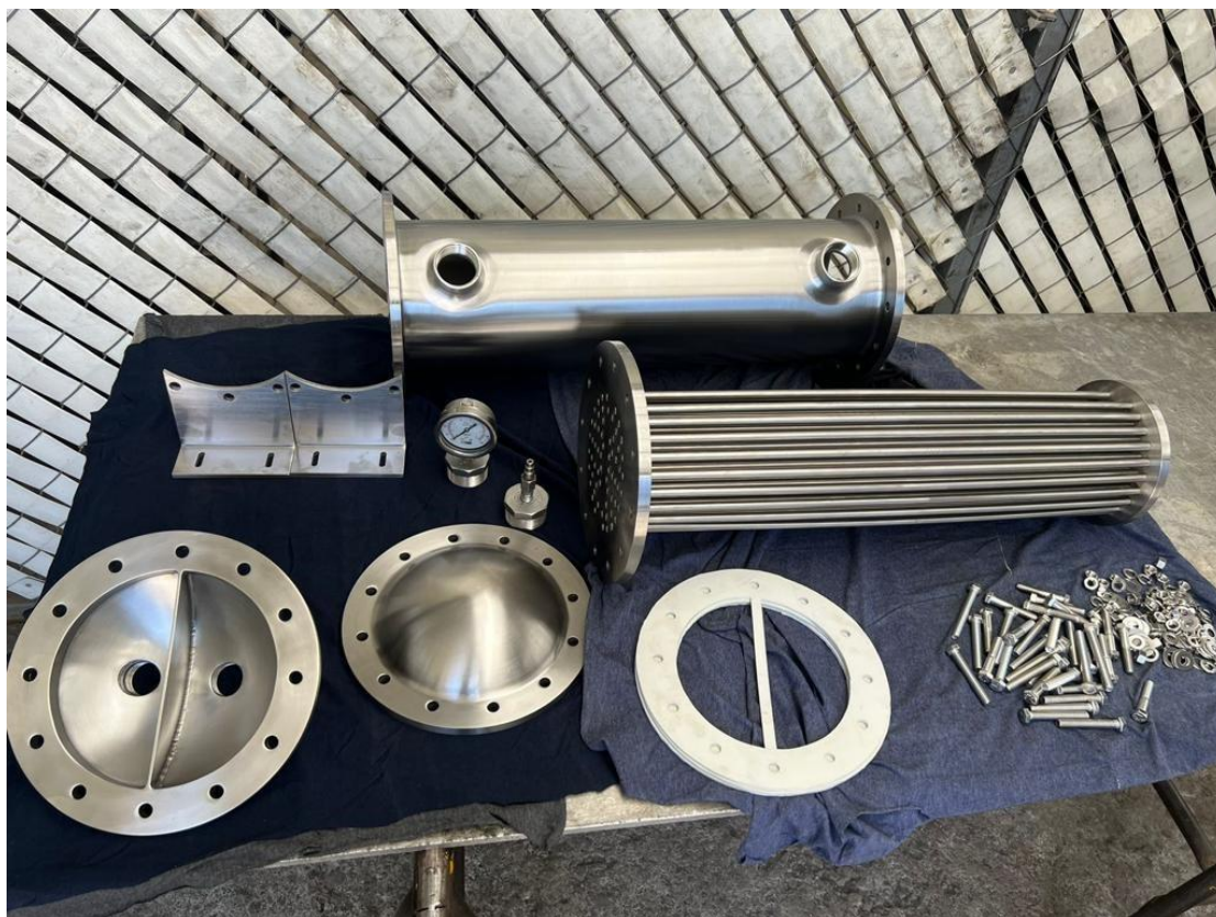
Figura 42 Partes del Intercambiador.
