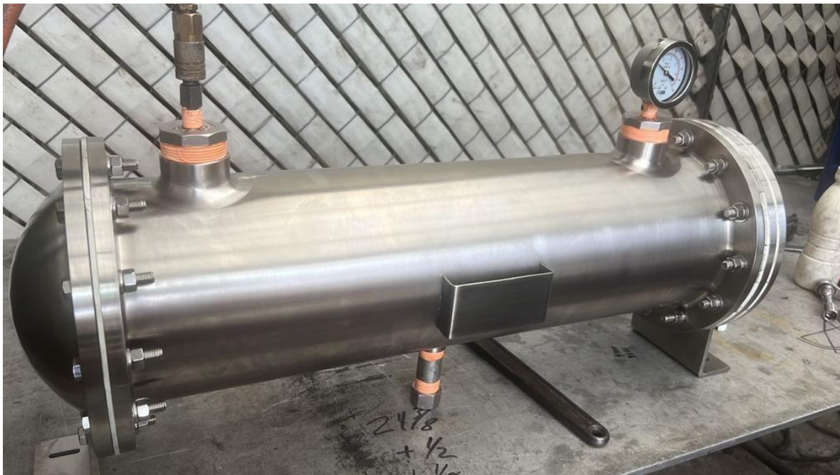
Figura 43 Intercambiador de Calor sometido a prueba neumática a 150lb.
