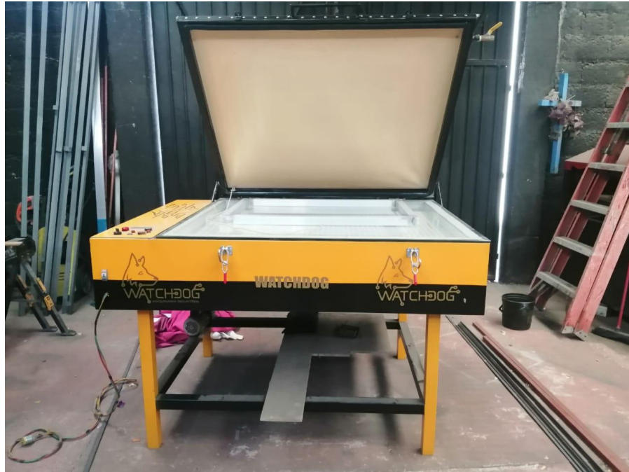
Figura 3.27 Estructura de la mesa de exposicion terminada vista frontal.
