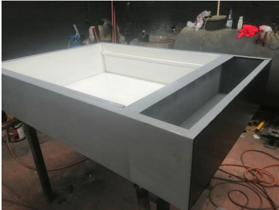
Figura 3.18 Interior de la mesa de revelado pintado.
