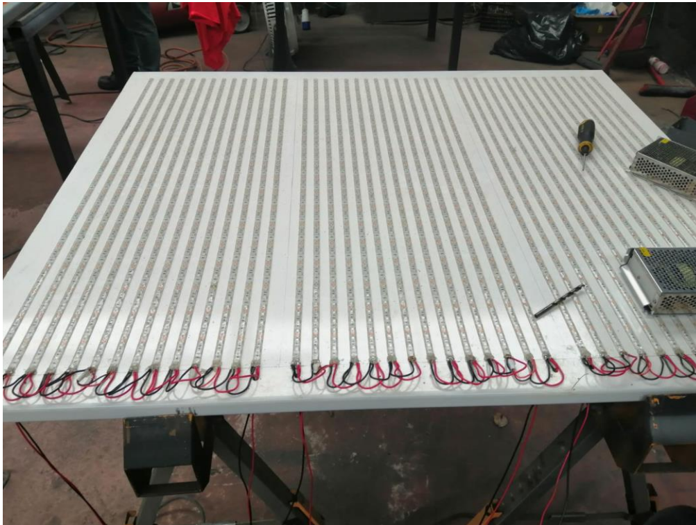
Figura 3.43 Conexión de las tiras led.
