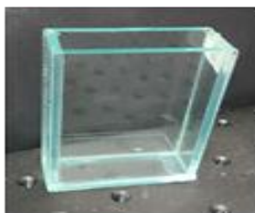
Figura 4. Celda de vidrio de 75 mm de alto, 50 mm de ancho, 15 mm de profundidad y una capacidad de 65 mL empleada para la preparación de las muestras.
