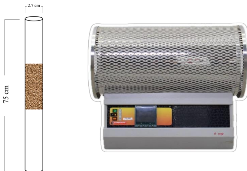
Figura 10. Horno tubular Carbolite Eurotherm y representación de la biomasa empacada en el tubo de cuarzo
