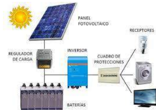
Figura 2.5 Componentes básicos de un sistema fotovoltaico (Díaz, 2015)
