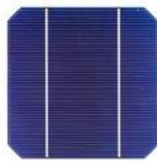
Figura 2.8 Celda poli-cristalina (quelepasaamicasa, 2022)
