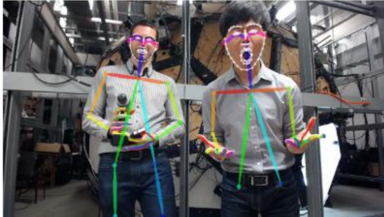
Figura 1.5 Estimación de pose multipersona OpenPose 2D, enlaces para cuerpo, manos y rasgos faciales tomado de [34]
