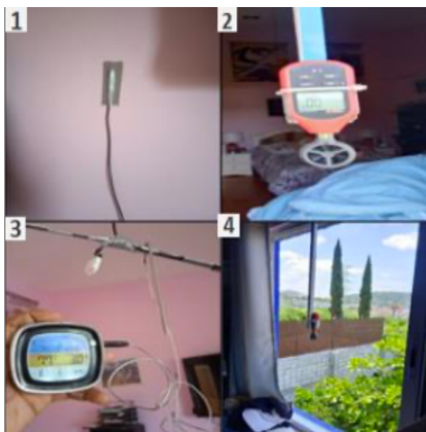
Figura 4.14 (1) Instalación de sensor de temperatura (2) Instalación de sensor de velocidad (3) Prueba de medición de temperatura en el centro de la habitación (4) Ventana de entrada de viento
