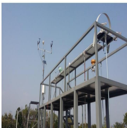
Figura 2.3 Estación Solarimétrica y meteorológica ESOLMET-IER-UNAM
