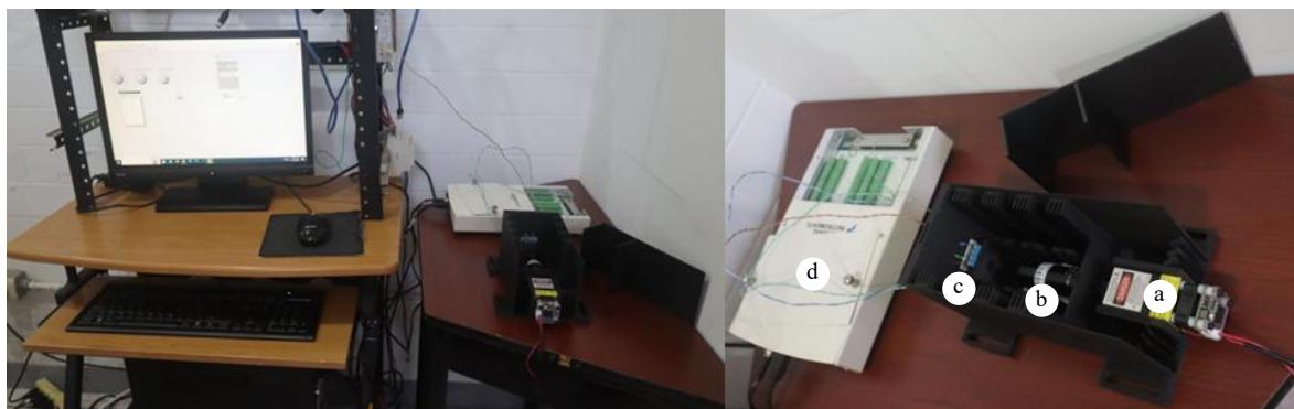
Figura 11. Sistema Óptico para realizar lecturas de fluorescencia para la determinación de afinidad tintórea de microplásticos. Consta de a) Láser azul, b) par de atenuadores para potencia de láser c) fotodiodo, d) tarjeta de adquisición de datos.
