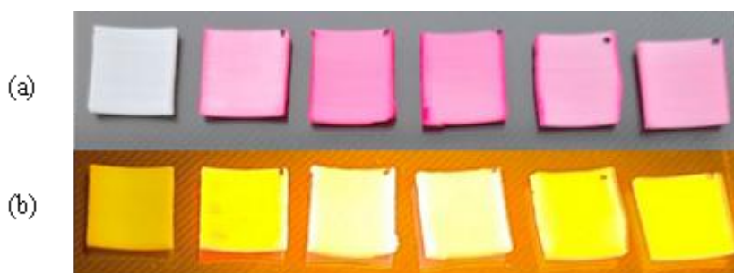
Figura 12 Muestras de PLA teñidas con colorante Rojo Nilo a diferentes concentraciones (0, 1, 2, 4, 6 y 8 ppm) observadas bajo (a) luz blanca y (b) radiación ultravioleta con filtro naranja.
