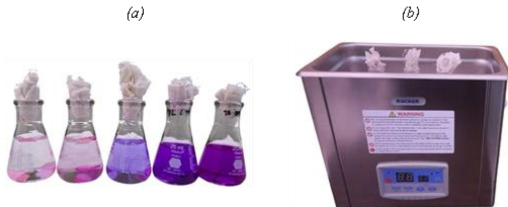
Figura 8. (a) Matrazes Erlenmeyer con MP de soluciones de RN a diversas concentraciones; (b) Proceso de tinción de MP en baño ultrasónico.
