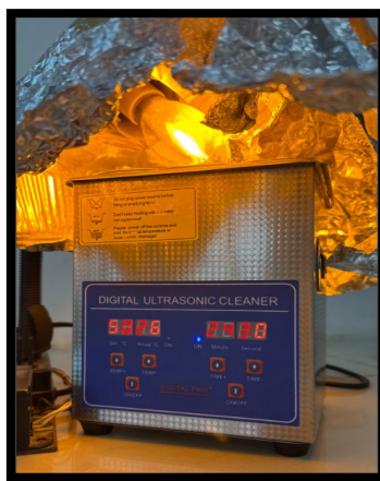
Figura 2.2 Incorporación de las nanopartículas de plata en la nanocelulosa bacteriana utilizando una lámpara de sodio y un agitador ultrasónico.
