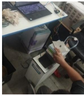
Figura 28. Prueba de sensores con baño termostático PolyScience.
