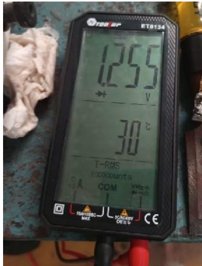
Fig. 0.22 Voltaje generado en cada celda Peltier.
