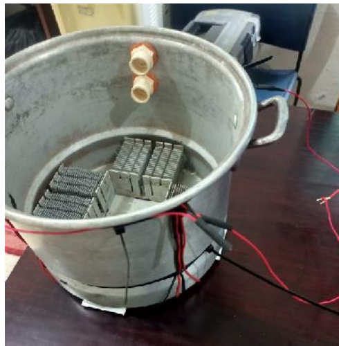
Fig. 0.17 Ensamble del Generador Termoeléctrico
