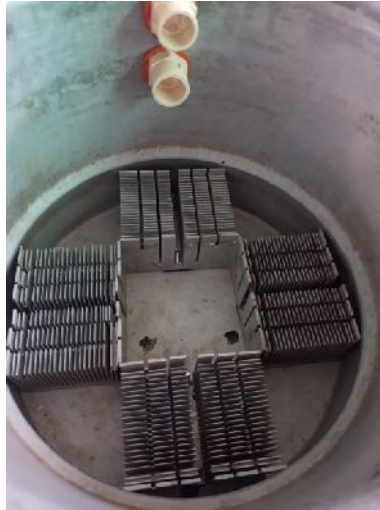
Fig. 0.12 Disipadores dentro del Recipiente
