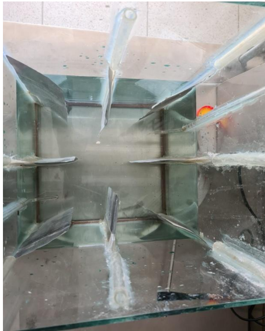
Ilustración 12: Disposición de las celdas de aluminio en el reactor.
