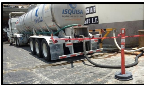
Figura 42: Delimitación del área de descarga/ muestreo de pipas de insumos químicos peligrosos.
