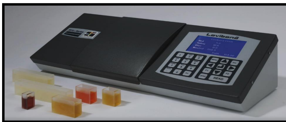
Figura 9: Equipo para medir el color en los aceites RBD (Refinado, blanqueado y desodorizado). Manual de operación Lovibond. Industrial aceitera, 2019
