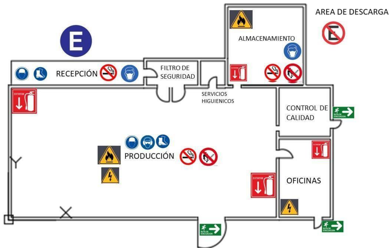
Ilustración 3 Layout de la planta piloto
