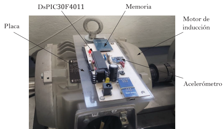
Figura D.3. Montaje del circuito con acelerómetro en MI.
