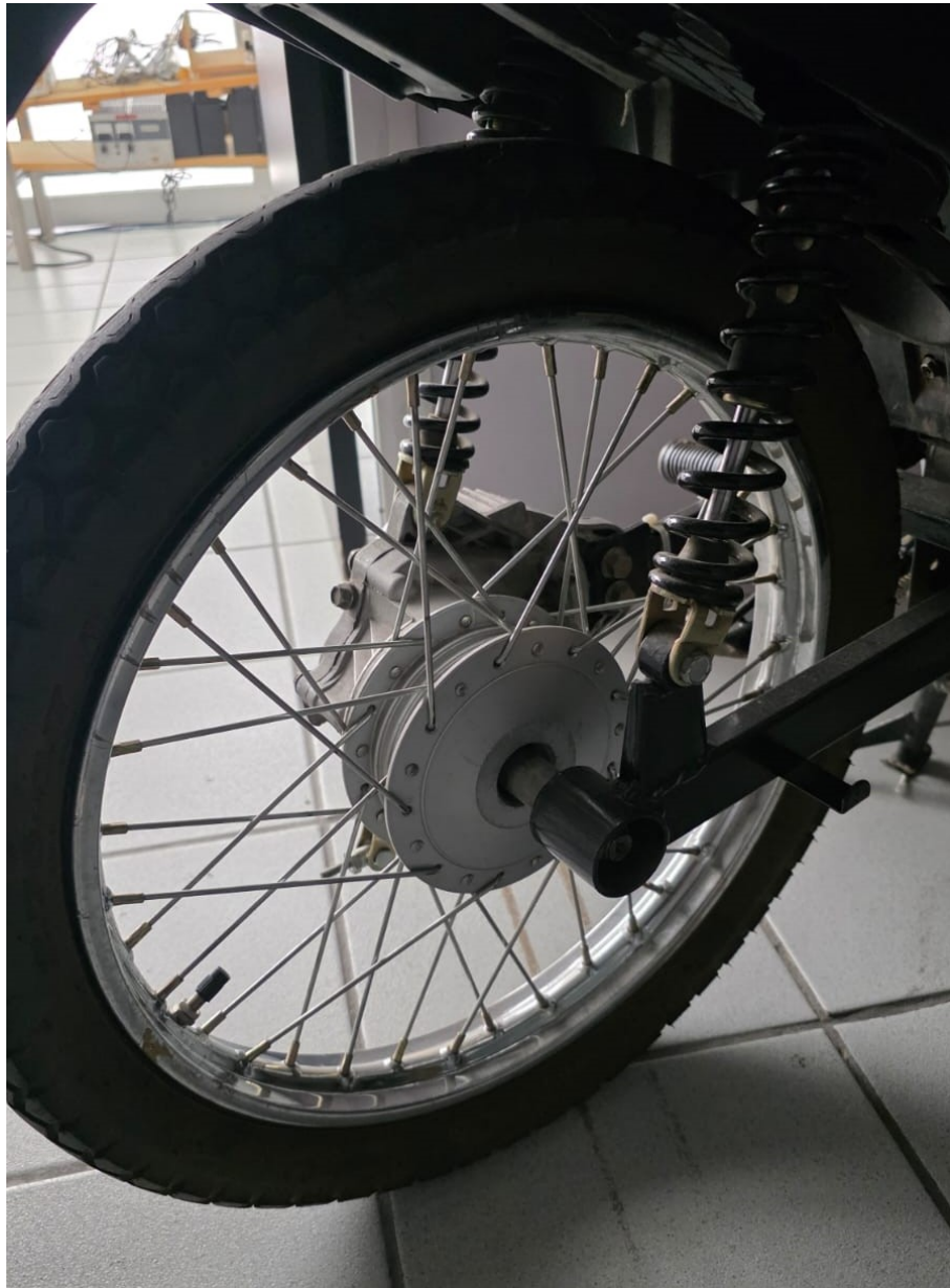
Figura 1.12. Aplicación de motor BLDC
