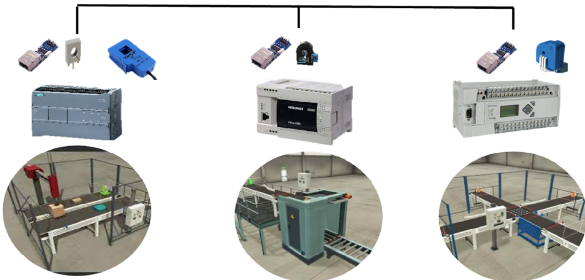
Figura 26 Disposición para diagnóstico activo descentralizado.
