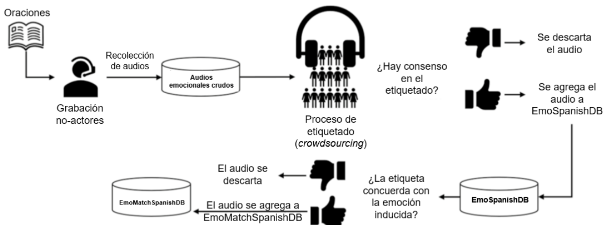
Figura 3.2. Diagrama de flujo del proceso utilizado para la creación de EmoSpanishDB y EmoMatchSpanishDB.
