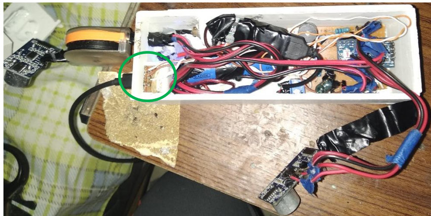
Figura 132.- Circuito colocado en la base con el cable retráctil instalado y soldado al PCB.
