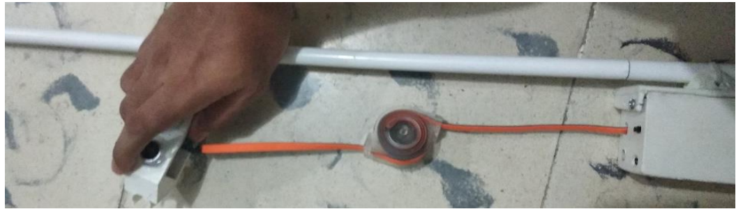
Figura 148.- Estirar el sensor para que se extienda el cable retráctil.
