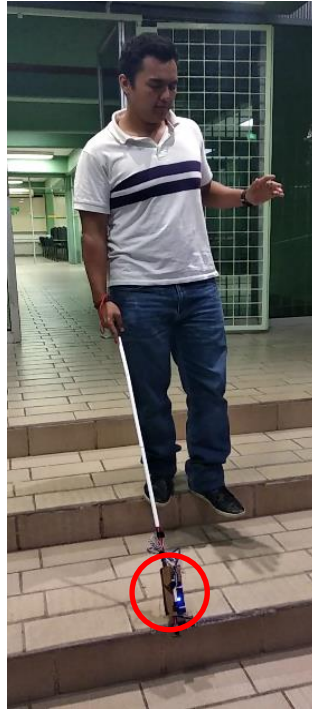
Figura 159.- Prueba de la versión 1, detectando el escalón.
