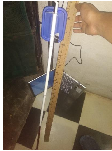
Figura 166.- Medición de distancia desde el sensor hasta el suelo.
