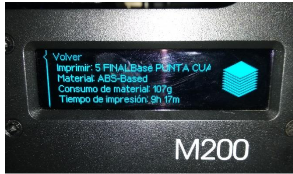
Figura 119.- Tiempo de impresión y material usado, desde la impresora.
