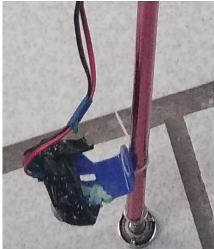
Figura 170.- Sensor ultrasónico inferior colocado en soporte de ultrasónico.
