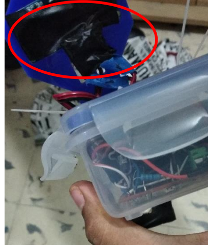
Figura 169.- Soporte ultrasónico radar con el sensor sujetado con cinta.
