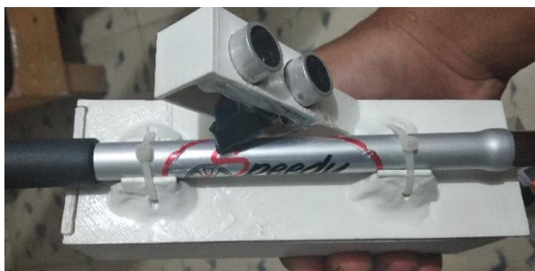
Figura 154.- Dispositivo Versión 4 implementado al bastón con cinchos.
