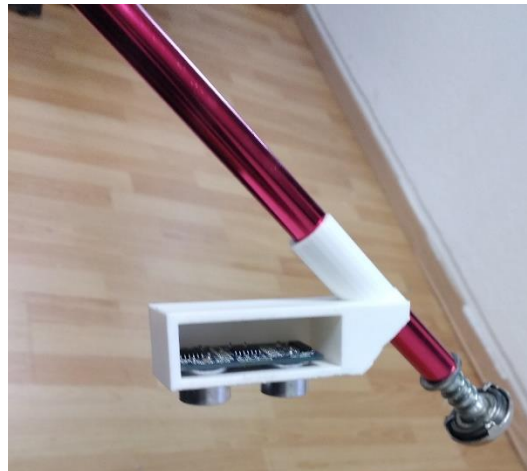
Figura 127.- Soporte de sensor ultrasónico impreso y colocado en el bastón.
