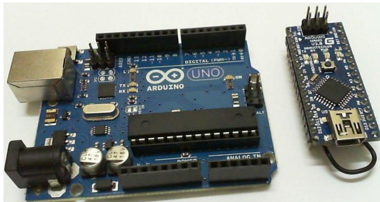
Figura 34.- Comparación de Arduino UNO (izquierda) y Arduino Nano.(derecha).
