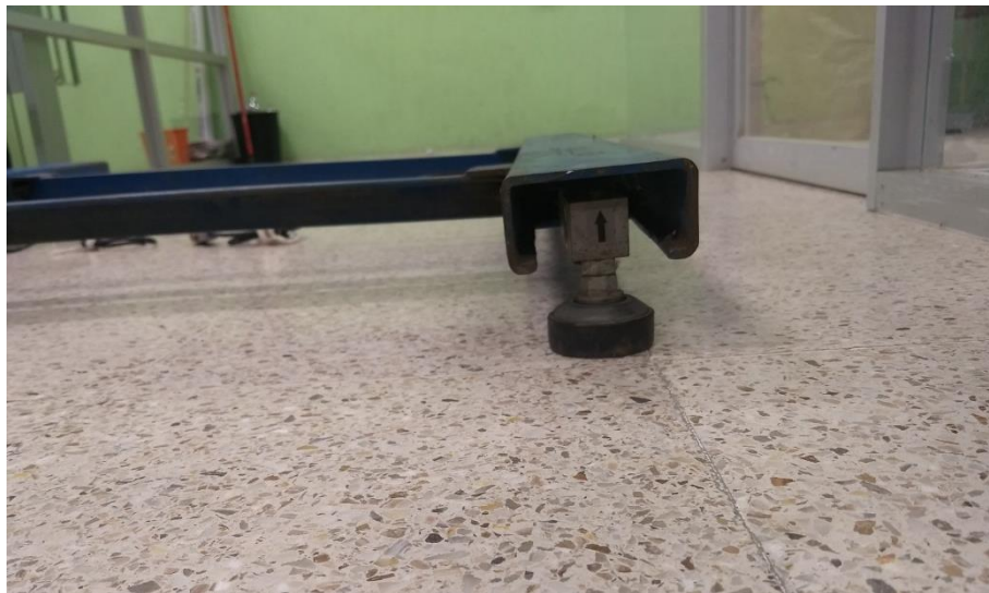
Figura 41. Celdas de cargas instalada en su viga de pesaje Fuente: Fotografía propia tomada en el ITVH
