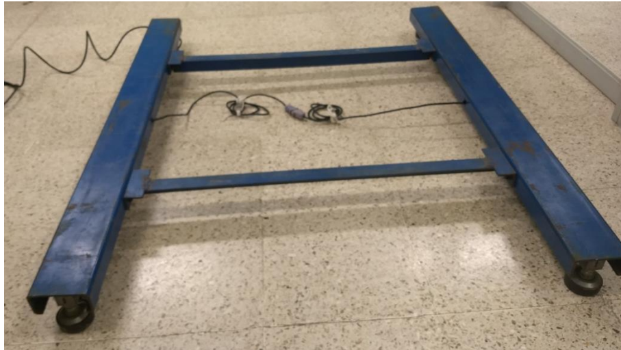
Figura 42. Barras de carga con sus cuatro celdas de pesaje Fuente: Fotografía propia tomada en las instalaciones del ITVH
