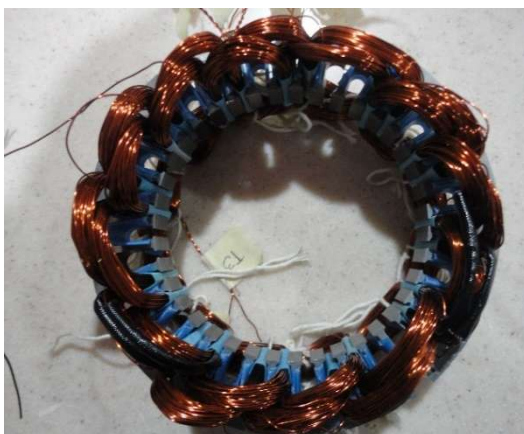
Figura A7. Montaje de las bobinas modificadas en el núcleo.
