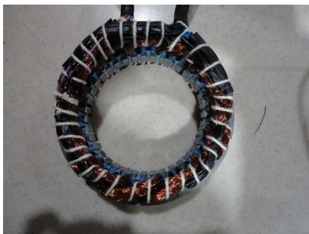
Figura A9. Estructura del devanado del estator después de la modificación.
