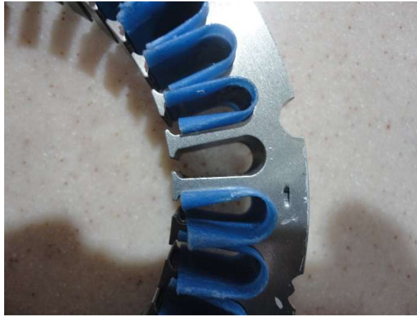
Figura A5. Acomodo el papel aislante en las ranuras del núcleo.
