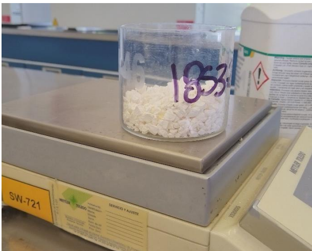
Ilustración 1.49 (Cantidad y volumen cloruro de calcio 2-6 mm)
