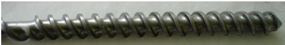
Figura 2.5. Husillo para extrusión del rPET.
