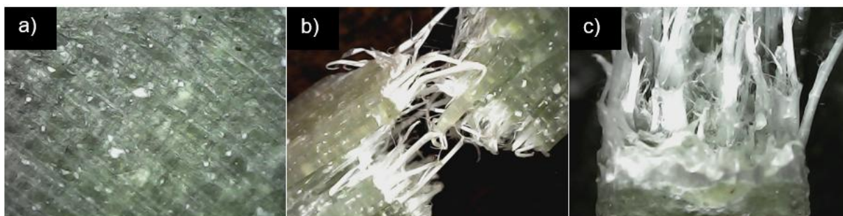
Figura 3.14. Micrografía óptica de probeta rPET/HAp 3 phr a) dispersión de partículas de HAp en matriz PET b) fractura dúctil c) sección transversal de la probeta
