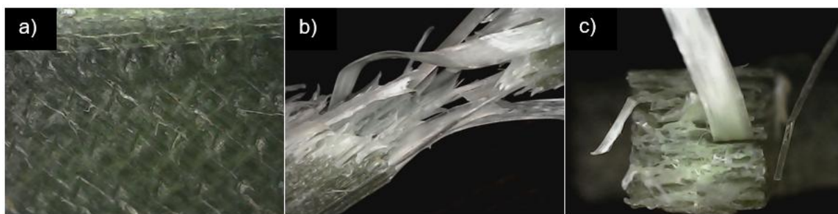
Figura 3.11. Micrografía óptica de probeta PET a) superficie de la probeta b) fractura dúctil c) sección transversal de la probeta
