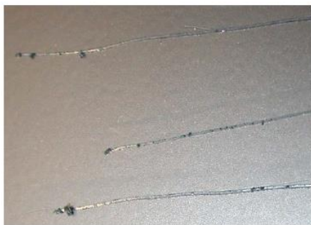
Figura 3 – Agrietamiento de la película de pintura hasta el sustrato (por reblandecimiento de la pintura)
