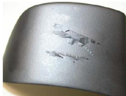
Figura 4 – Agrietamiento y rasguño profundo de la pintura
