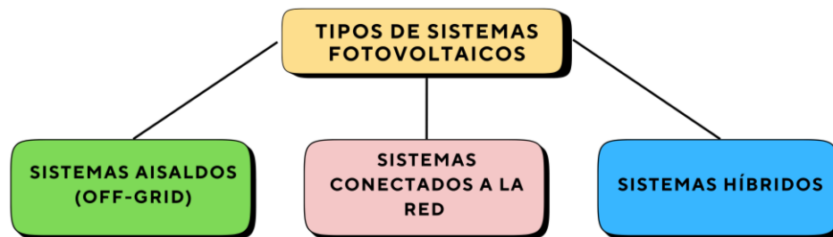
Figura 2. 7: Diagrama general de la clasificación de los sistemas fotovoltaicos.
