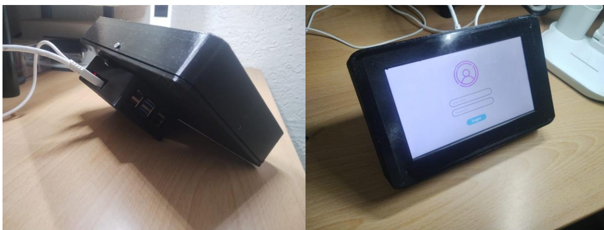
Figura 4. 12: Carcasa impresa en 3D para interfaz gráfica y Raspberry Pi 4.
