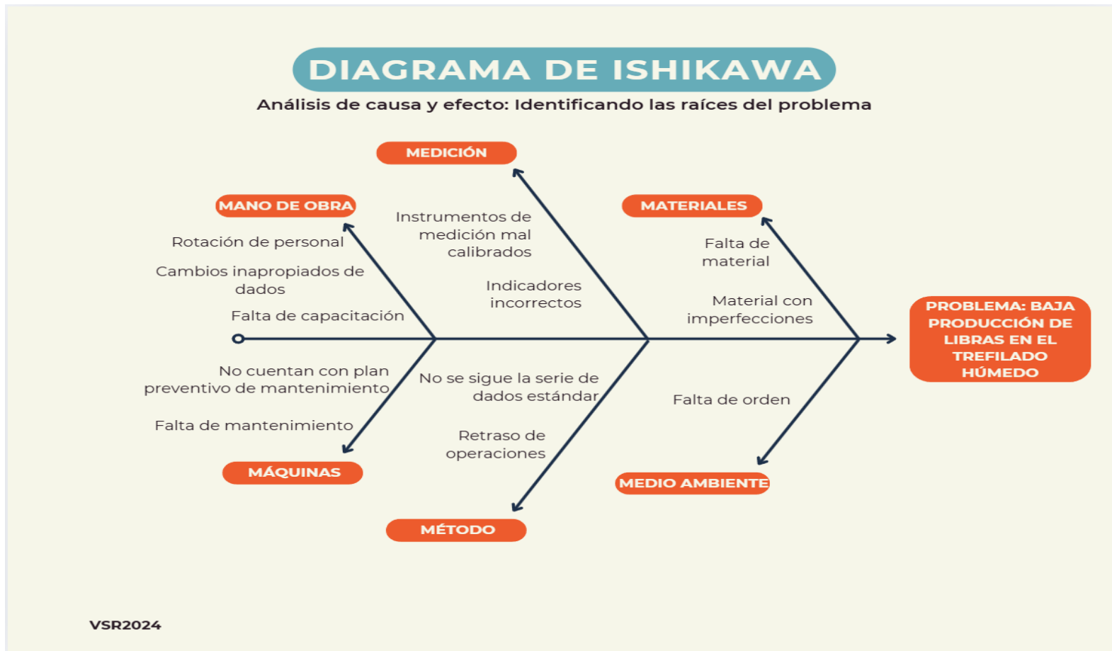
Ilustración 26. Diagrama de Ishikawa (Baja producción de libras en el Trefilado Húmedo). Fuente: Elaboración propia
