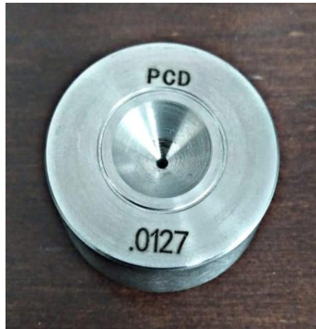
Ilustración 10 Ejemplo de un dado de diamante tipo PCD. Fuente: Elaboración propia.
